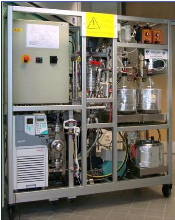
Miniplant-Anlage zur Herstellung von Nanopartikeln
