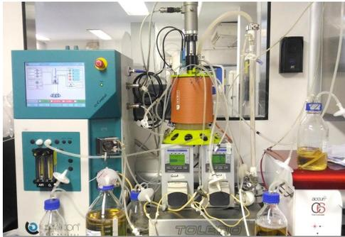
Ein Filter sorgt dabei dafür, dass die Zellen und die Viren im Reaktor bleiben, während das benutzte Medium ausgetauscht wird. In dem Bioreaktor lassen sich Temperatur, Sauerstoff, und pH-Wert kontrollieren und so einstellen, dass sich die Viren optimal vermehren können. Nach knapp zwei Wochen konnten die Wissenschaftler fast 40 Millionen infektiöse Viren pro Milliliter ernten. Dies ist ausreichend für eine Vielzahl von virologischen Studien.
